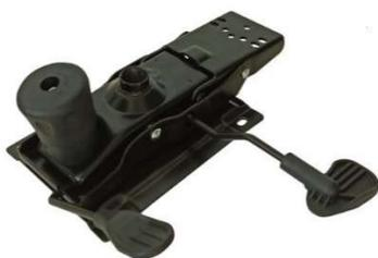
Dispone de cuatro puntos de anclaje, con dos palancas a la derecha; extrayendo la palanca trasera lateralmente activamos el mecanismo y al insertarla lo fijamos. Pulsando hacia arriba se regula la altura del asiento. La palanca delantera regula la profundidad del asiento. Pulsando hacia arriba liberamos el asiento para el movimiento y soltando lo fijamos.
