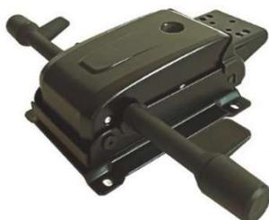
Dispone de cinco puntos de anclaje, con dos palancas. Con la derecha, girando el pomo regula la tensión del respaldo y pulsando hacia arriba se regula la altura del asiento. Con la palanca de la izquierda, girando el pomo activamos el mecanismo y pulsando la palanca regulamos la profundidad del asiento para el movimiento y soltando lo fijamos.
