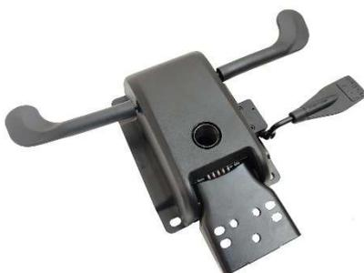
Dispone de cuatro puntos de anclaje, con dos palancas. Pulsando hacia arriba la palanca situada a la derecha se regula la altura del asiento. En el lado izquierdo hay dos palancas, con la palanca delantera activamos el mecanismo que se ajusta automáticamente según peso del usuario y con la palanca trasera regulamos la profundidad del asiento, pulsando hacia arriba liberamos el asiento para el movimiento y soltando lo fijamos.
