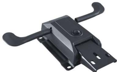
Dispone de cuatro puntos de anclaje, con dos palancas. Pulsando hacia arriba la palanca situada a la derecha se regula la altura del asiento. Con la palanca de la izquierda activamos el mecanismo que se ajusta automáticamente según peso del usuario.
