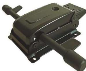
Dispone de cinco puntos de anclaje, con dos palancas. Con la derecha, girando el pomo regula la tensión del respaldo y pulsando hacia arriba se regula la altura del asiento. La palanca de la izquierda, girando el pomo activamos el mecanismo y pulsando la palanca regulamos la profundidad del asiento para el movimiento y soltando lo fijamos.
