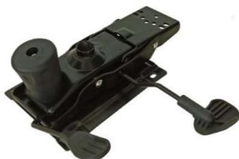
Dispone de cuatro puntos de anclaje, con dos palancas a la derecha; la trasera con movimiento lateral activamos el mecanismo y pulsando hacia arriba se regula la altura del asiento. La delantera regula la profundidad del asiento. Pulsando hacia arriba liberamos el asiento para el movimiento y soltando lo fijamos.
